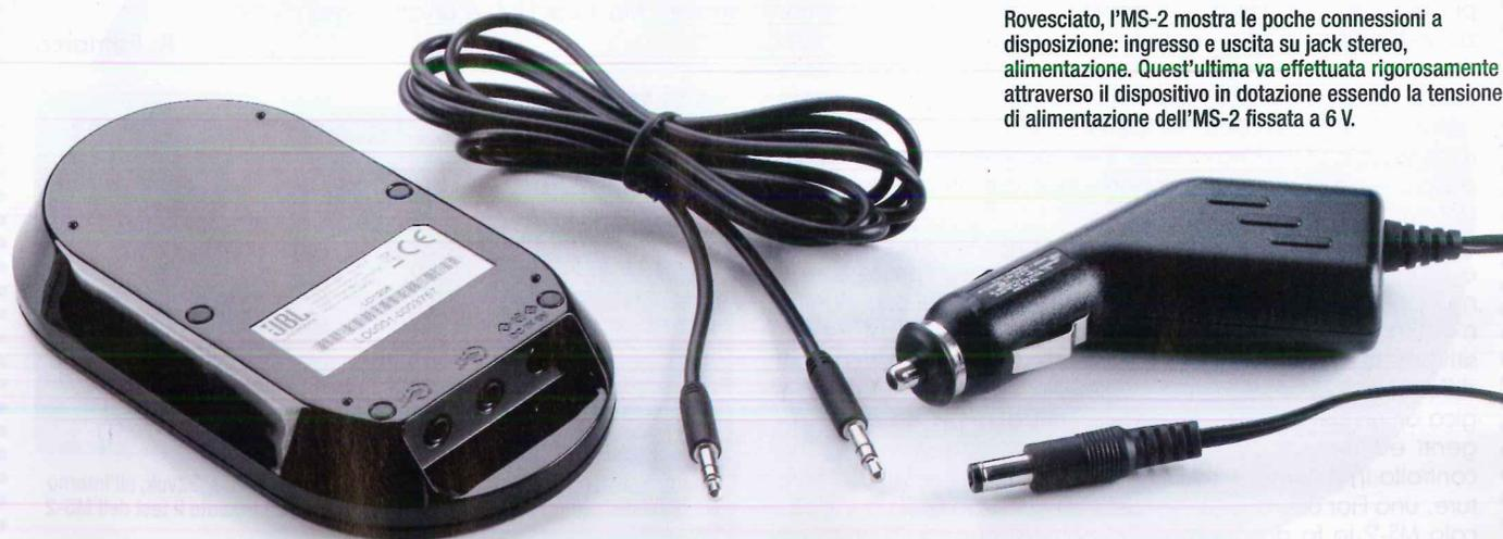
Rovesciato, l'MS-2 mostra le poche connessioni a disposizione: ingresso e uscita su jack stereo, alimentazione. Quest'ultima va effettuata rigorosamente attraverso il dispositivo in dotazione essendo la tensione di alimentazione dell'MS-2 fissata a 6 V.
